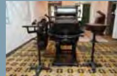
Máquina de impressão Minerva da marca Phoenix Presse, fabricada na Alemanha por Schelter & Giesecke S.G., nas décadas de 1930 ou 1940. Funciona com energia eléctrica EMS.2010.00125.00000
